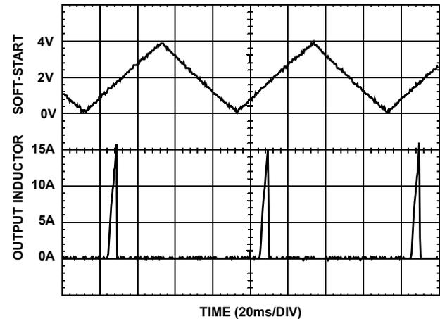
FIGURE 4. OVERCURRENT OPERATION
