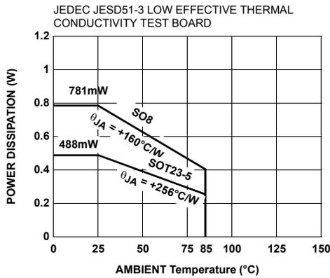
**FIGURE 48. PACKAGE POWER DISSIPATION vs AMBIENT TEMPERATURE**
