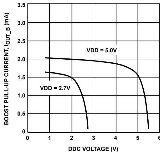
FIGURE 7. BOOST PULL-UP CURRENT vs DDC VOLTAGE
