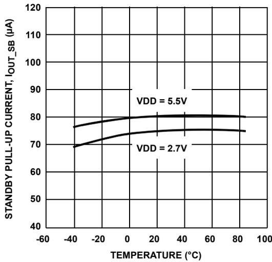
FIGURE 3. STANDBY PULL-UP CURRENT, DDC1, 2 = V<sub>DD</sub> - 0.5V
