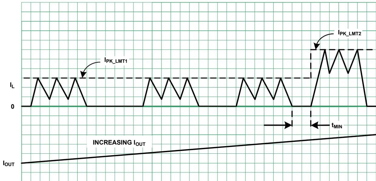
FIGURE 16. PEAK CURRENT LIMIT STEP UP TRANSITION
