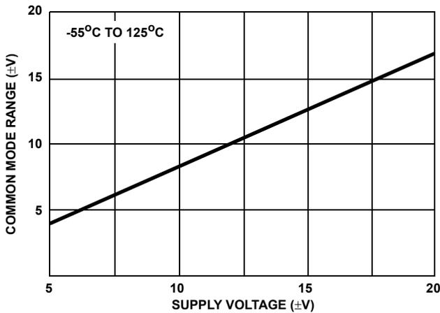
FIGURE 10. COMMON MODE VOLTAGE RANGE vs SUPPLY VOLTAGE
