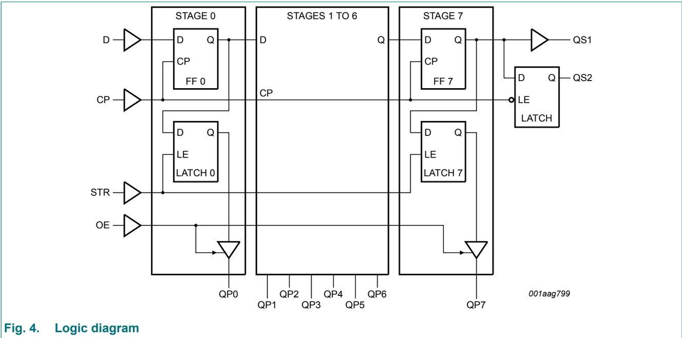
Fig. 4. Logic diagram
