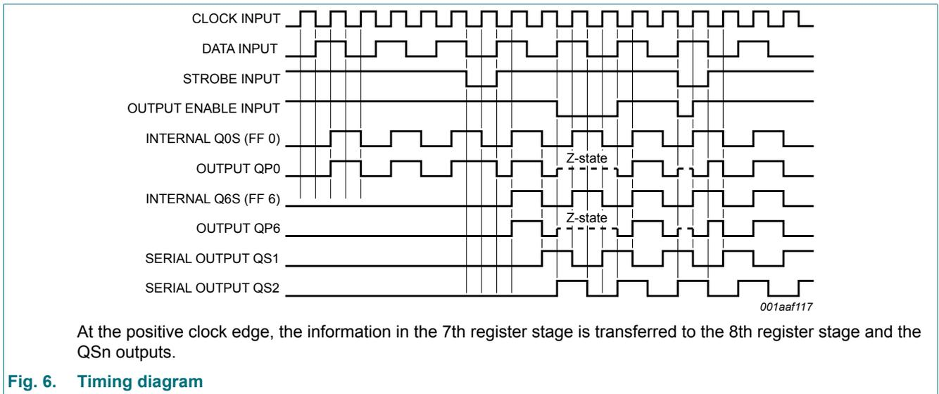
**Fig. 6. Timing diagram**
