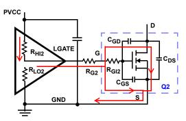
FIGURE 4. TYPICAL LOWER-GATE DRIVE TURN-ON PATH
