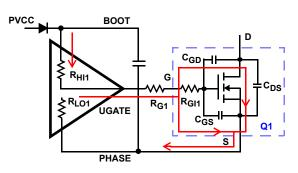
FIGURE 3. TYPICAL UPPER-GATE DRIVE TURN-ON PATH
