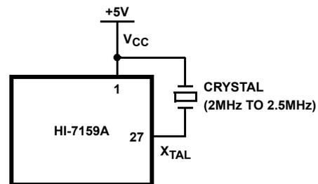
FIGURE 7. SINGLE-PIN OSCILLATOR
