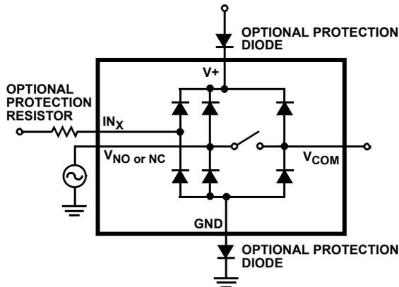
FIGURE 8. OVERVOLTAGE PROTECTION
