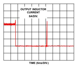
FIGURE 1. OVERCURRENT OPERATION
