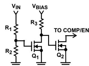
FIGURE 6. SEQUENCER CIRCUIT
