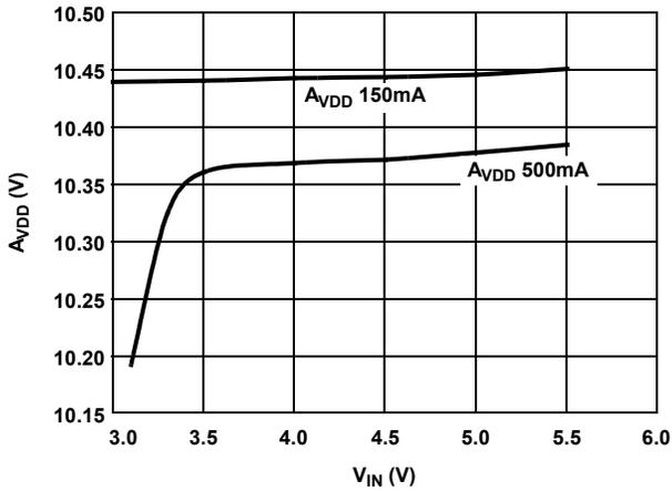
FIGURE 3. LINE REGULATION A<sub>VDD</sub> vs V<sub>IN</sub>
