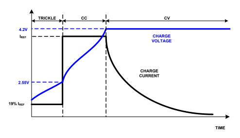
FIGURE 2. TYPICAL CHARGE PROFILE
