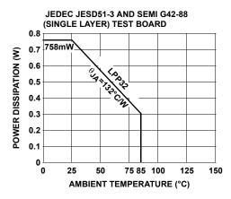
FIGURE 11. POWER DISSIPATION vs AMBIENT TEMPERATURE
