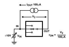
FIGURE 1. ON RESISTANCE TEST CIRCUIT
