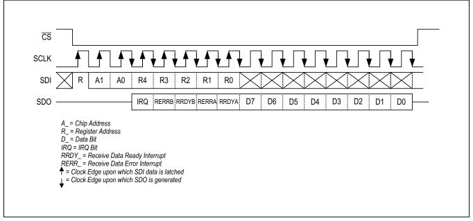
Figure 7. SPI Byte-by-Byte Read Cycle
