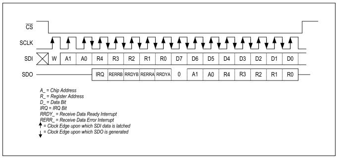
Figure 6. SPI Byte-by-Byte Write Cycle
