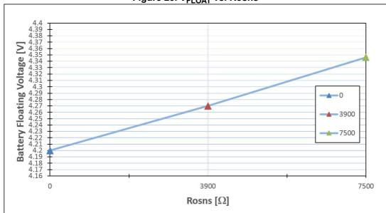
Figure 23. V<sub>FLOAT</sub> vs. Rosns
